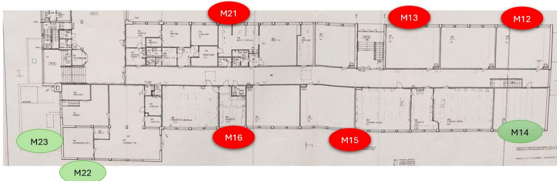
Pohjakuva 15. Seinien mikrobimateriaalinäytteenottopisteet luokkasiipi
