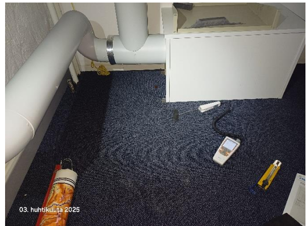
Kuva 26. Viiltomittaus tekstiilipalamaton alta.
