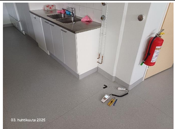
Kuva 28. Viiltomittaus kotitalousluokan pinnoitteena olevan muovimaton alta.
